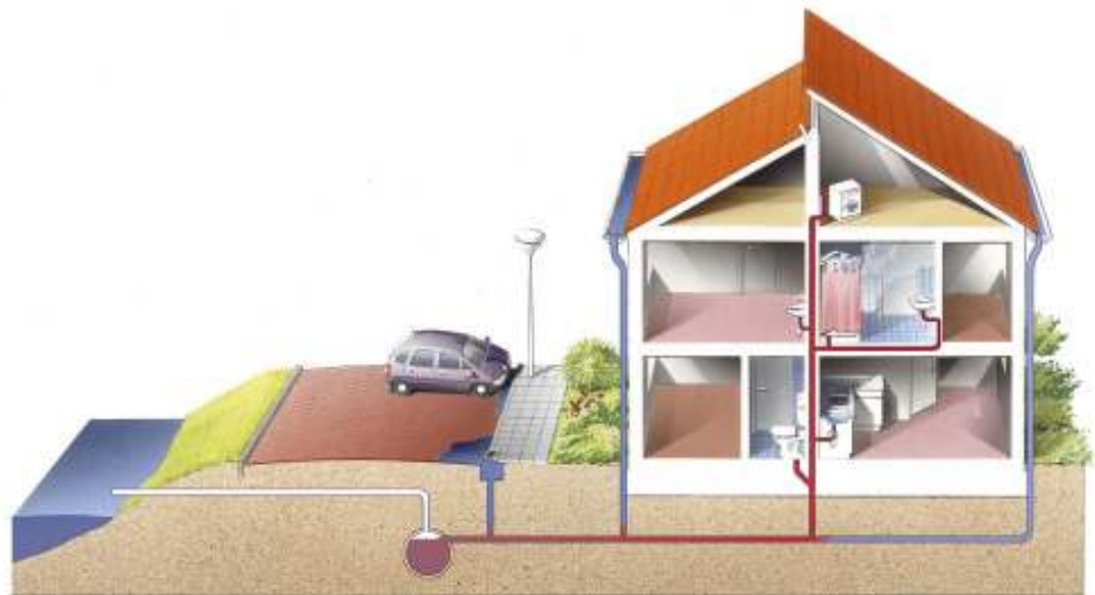
Figuur 2.1: Huis- en kolkaansluiting op het gemengd riool met overstort.
